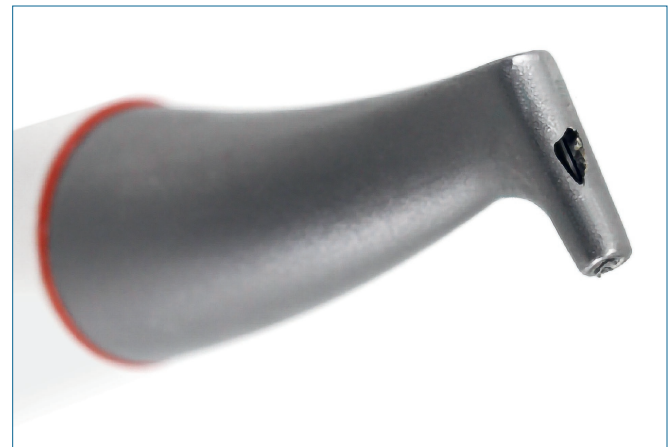
Abb. 7 Für die Sicherheit der Patienten und eine lange Lebensdauer des Instruments muss das verwendete Pulver auf dieses perfekt abgestimmt sein. Das Bild zeigt die beschädigte Düse eines Airflow-Handstücks nach Anwendung eines mit Apatit beschichteten Pulvers (vgl. Abb. 5).
